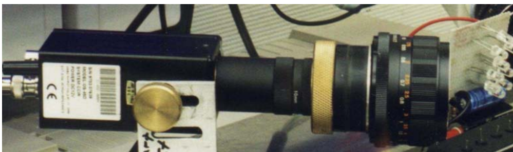
Abbildung 1.10: Video-Kamera mit Zwischenringen (gelber Ring und schmalere Ringe links davon) zwischen Linse (rechts) und Kamera-Gehäuse (links) für Nahaufnahmen von Arabidopsis -Keimlingen. Ganz rechts erkennt man einen Satz Infrarot-Leuchtdioden, mit denen die Keimlinge beleuchtet werden. /CN-tubus
