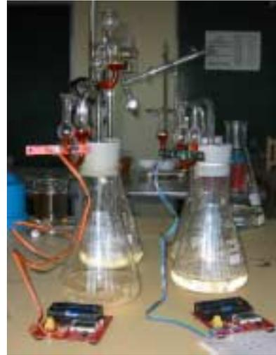
Abb. 11 Monitoring mit einem Blasenähler
