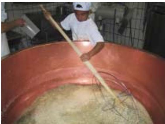
*Abb. 6 Schneiden des Molkebruchs mit der Käseharfe*
